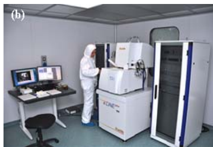
(b) Instalație de nanolitografiere cu fascicul de electroni de rezoluție ultraînaltă
