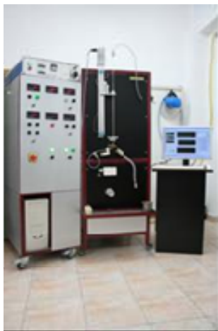
Instalație pentru prepararea micro- și nanofirelor metalice acoperite cu sticlă (brevet EP, US, CA).
