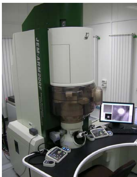
Fig. 2. Microscopul electronic de transmisie, de înaltă rezoluție, ARM-200F, achiziționat de la EOL în cadrul proiectului finanțat din programul POS-CCE.
